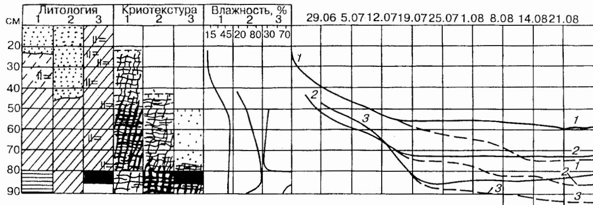
Рис. 4. Ход изменения глубины оттаивания по трем мерзлотомерам, расположенным на ненарушенной части оползневого склона.
