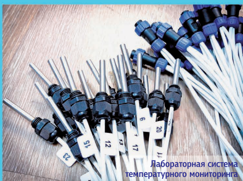
Установка для определения температуры начала замерзания/оттаивания грунта
