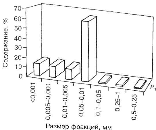
Рис. 3. Гранулометрический состав мерзлой супеси выработки ГКМ.
