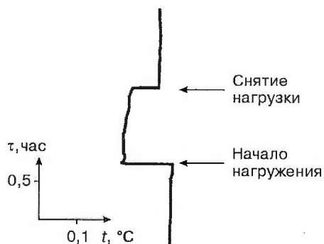
Рис. 3. Изменение температуры мерзлого грунта под нагрузкой.
