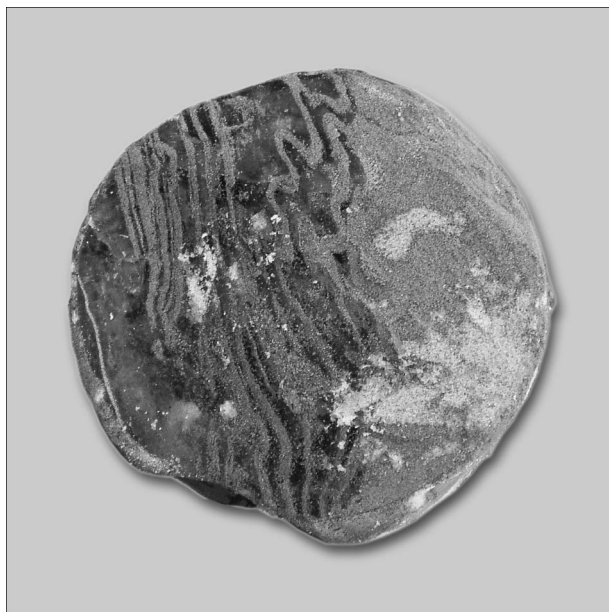
Рис. 3. Керн скважины С-1, содержащий фрагмент песчано-ледяной жилы (фото В.В. Куницкого).
