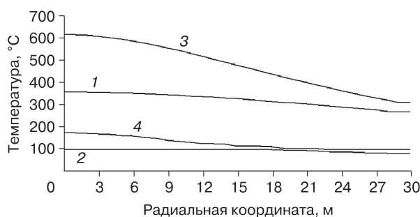
Рис. 3. Зависимость температуры поверхности грунта от удаления до оси размещения источника тепла, расположенного на высотах H :
