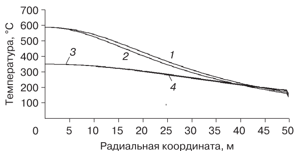
Рис. 5. Зависимость температуры поверхности грунта от удаления до начала координат.
