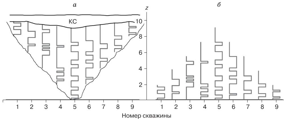
Рис. 1. Распределения пористости неконсолидированной части киля тороса в отдельных скважинах (а) и при сдвиге до горизонта максимальной осадки киля (б).
