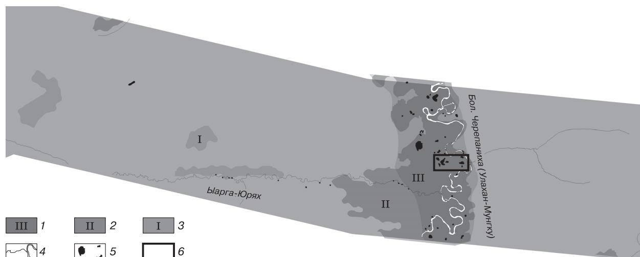
Рис. 2. Фрагмент карты районирования буферной зоны магистрального нефтепровода по условиям, способствующим формированию термокарста на участке пересечения с р. Большая Черепаниха:
