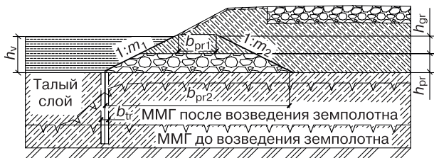
Рис. 3. Вариативные геометрические параметры конструктивно-технологического решения.
