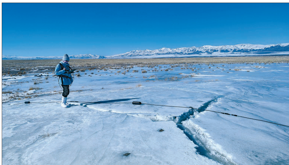
Рис. 2. Зондирования методом бесконтактного измерения электрического поля (БИЭП) на наледном бугре.
