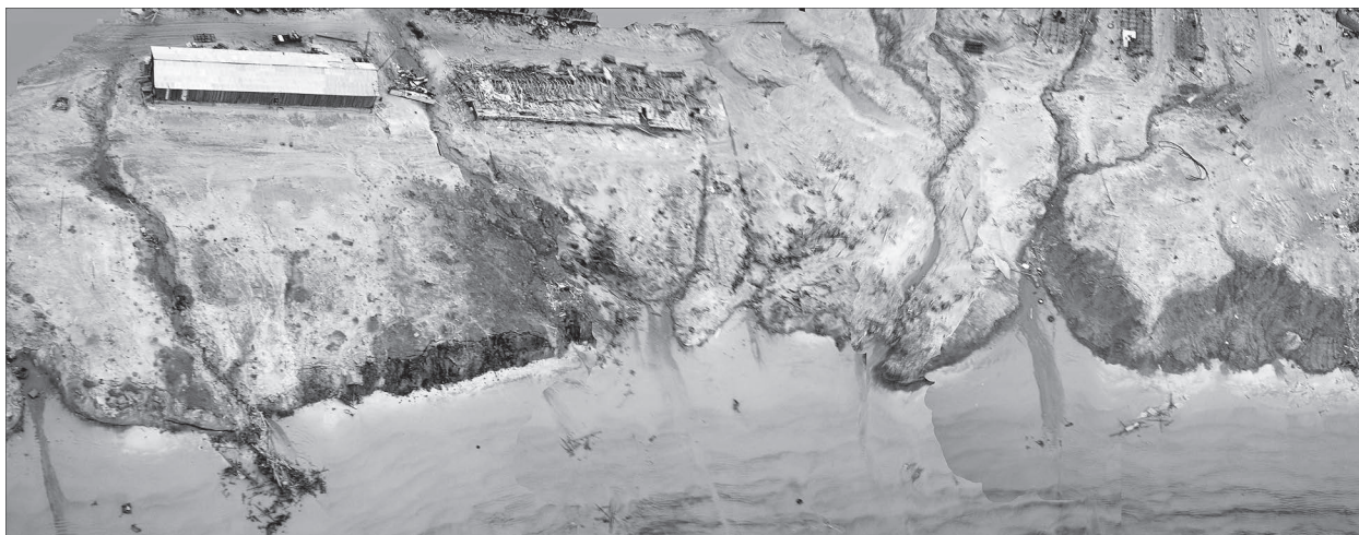
Рис. 6. Вдольбереговая овражная эрозия в районе пос. Харасавэй (октябрь 2007 г.).
