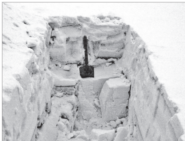
Рис. 5. Плита из уплотненного мелкозернистого снега, из которого готовили блоки для контрольных измерений.
