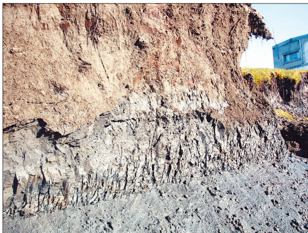
Рис. 3. Криогенное строение современных склоновых отложений, промерзших снизу от залежи льда, в расчистке 227.
