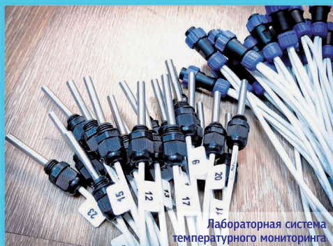
Установка для определения температуры начала замерзания/оттаивания грунта
