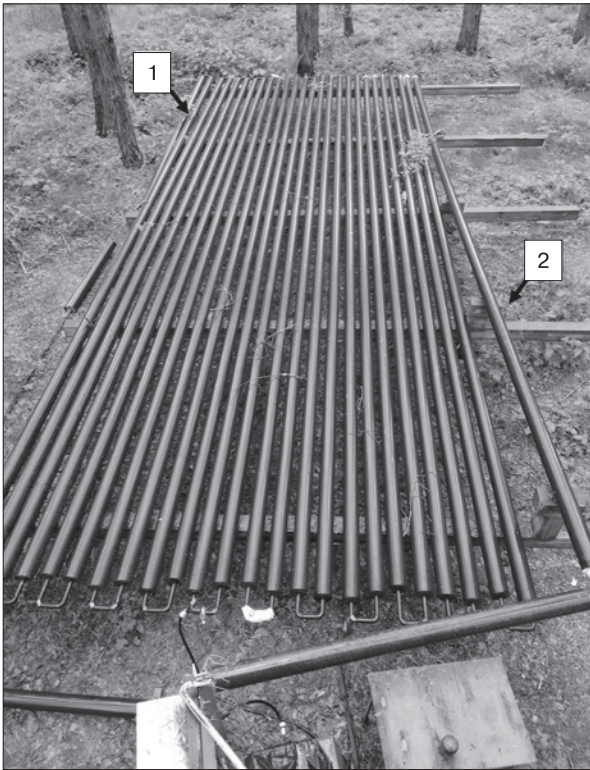
Рис. 10. Испарительная система экспериментальной установки.
